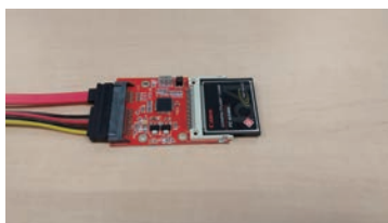
CompactFlash を CF→SATA 変換アダプターに接続した状態
